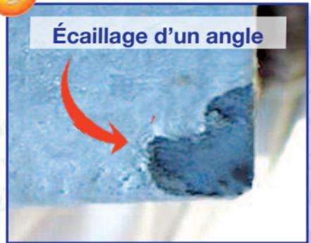
Photos 14, 15, 16 et 17 : Défauts de surface dus au découpage des pièces
