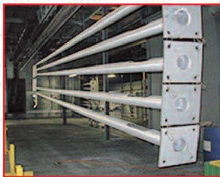
Photos 73, 74, 75 et 76 : Pièces galvanisées à chaud et thermolaquées
