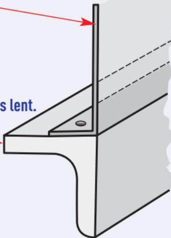
Figure 20 : Comment éviter la déformation d'une tôle fine
