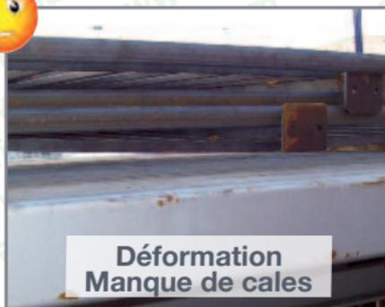
Photos 64 et 65 : Les conséquences d'un mauvais colisage
