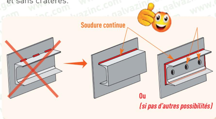
Figure 24 : La continuité des cordons de soudure
